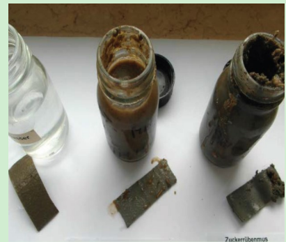
Testergebnis: Keine Korrosion durch Zuckerrübensilage.
