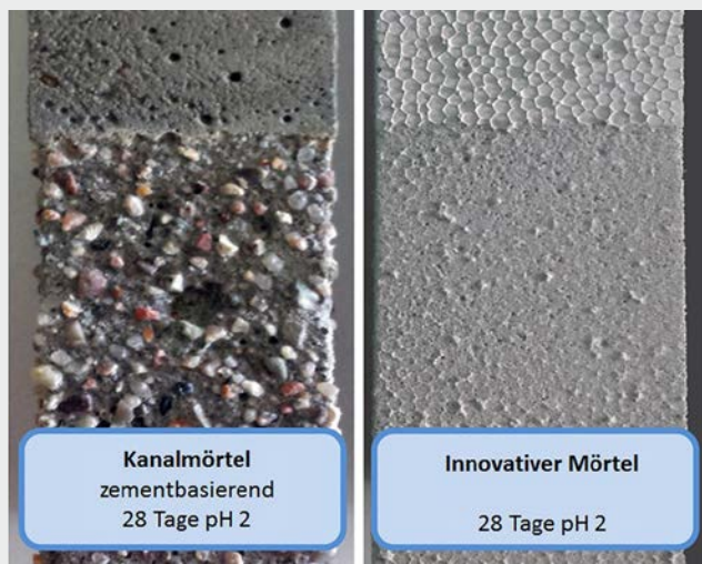
Fig. 5 Vergleich zwischen einem silikatischen Mörtel und einem Kanalmörtel – beide gelagert in Schwefelsäure für 28 Tage bei pH = 1 (Quelle 5-7: Maleki GmbH)
